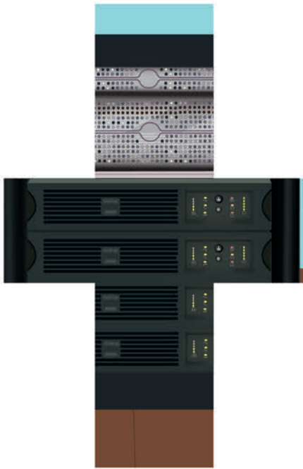
Sistema de alimentación ininterrumpida (SAI) Uninterruptible power supply (UPS)
